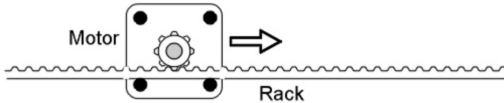
**Fig. 5.4 Rack & Pinion**
